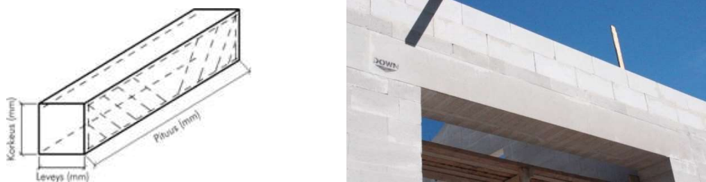
Kuva 3.8 bauroc PALKKI. Merkintä DOWN ja nuoli osoittaa palkin alapinnan asennussuunnan
