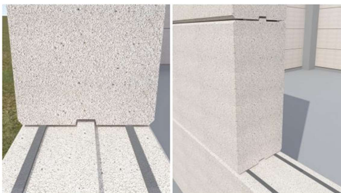
Kuva 3.10 bauroc SEINÄELEMENTIN vaakasaumaliitos tiivistysnauhalla. Vaihtoehtoinen tapa on laastikiinnitys, jota käytetään ainakin palomuuureissa.
