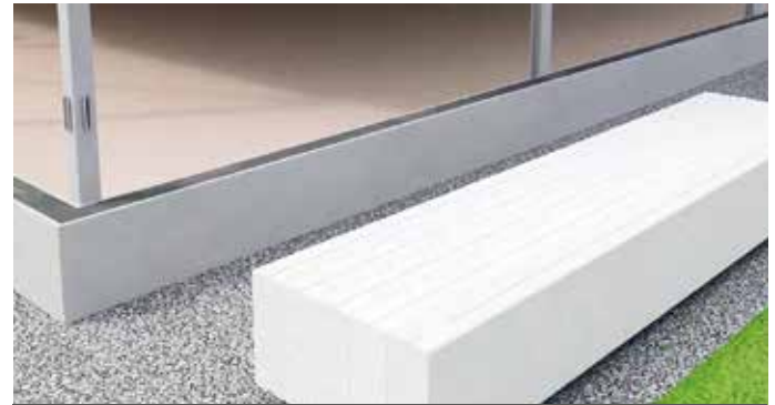
Ensimmäisen elementtikerroksen alla laitetaan vedeneristyskaista
